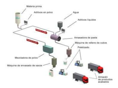
Se reciben las materias primas en la planta de fabricación, donde se pesan y mezclan de acuerdo con la formulación. Una vez mezcladas, el producto se envasa en sacos para su almacenamiento en palets hasta la distribución el producto.
