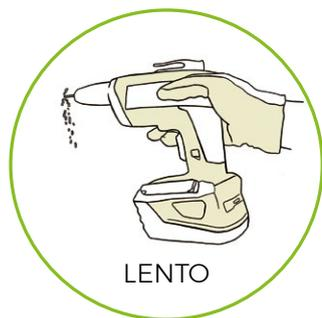
Atornillar la placa Pladur® **SOLIDTEX** con los tornillos Pladur® **SOLIDTEX** cuya longitud sea la adecuada al espesor de placa(s) del sistema.
