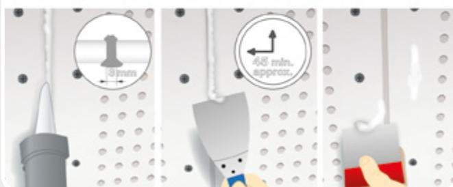
**Traitement des joints :** en raison de l'espace réduit entre les perforations, Pladur® recommande le traitement des joints sans bande avec la pâte Pladur® TL, en remplissant le joint avec la pâte préparée à l'aide du pistolet applicateur. Ce traitement est également recommandé pour les joints des bords carrés (transversaux et découpes du panneau) du panneau Pladur® FON+ BA.
