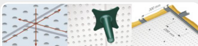
**Vissage des plaques :** vérifier l'alignement des trous dans le sens de la longueur, de la largeur et de la diagonale avec les outils de montage Pladur® FON+, et visser les plaques aux profilés tous les 200 mm maximum.
