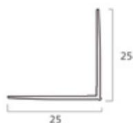
Profilé en PVC pour finition d'angles droits en coin. Flexible et adaptable à la surface.
