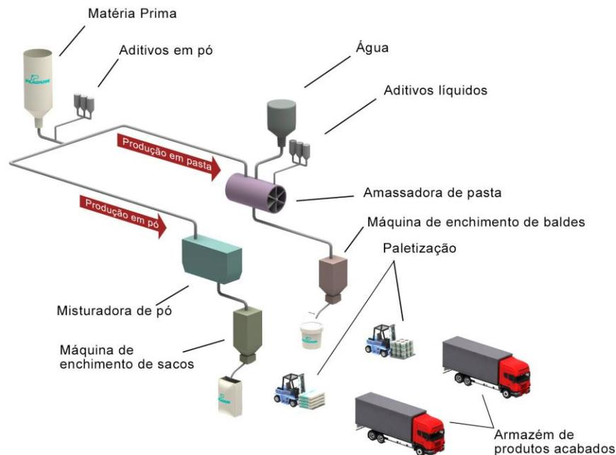
As matérias-primas são recebidas na unidade de fabrico, onde são pesadas e misturadas de acordo com a formulação. Depois da mistura, o produto é acondicionado em sacos e armazenado em paletes até ser distribuído.
