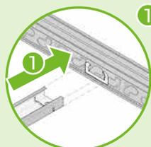
1 Introduce la boca del secundario (Extremo A), en la perforación del alma del perfil primario, hasta que su ranura sobrepase el alma.
