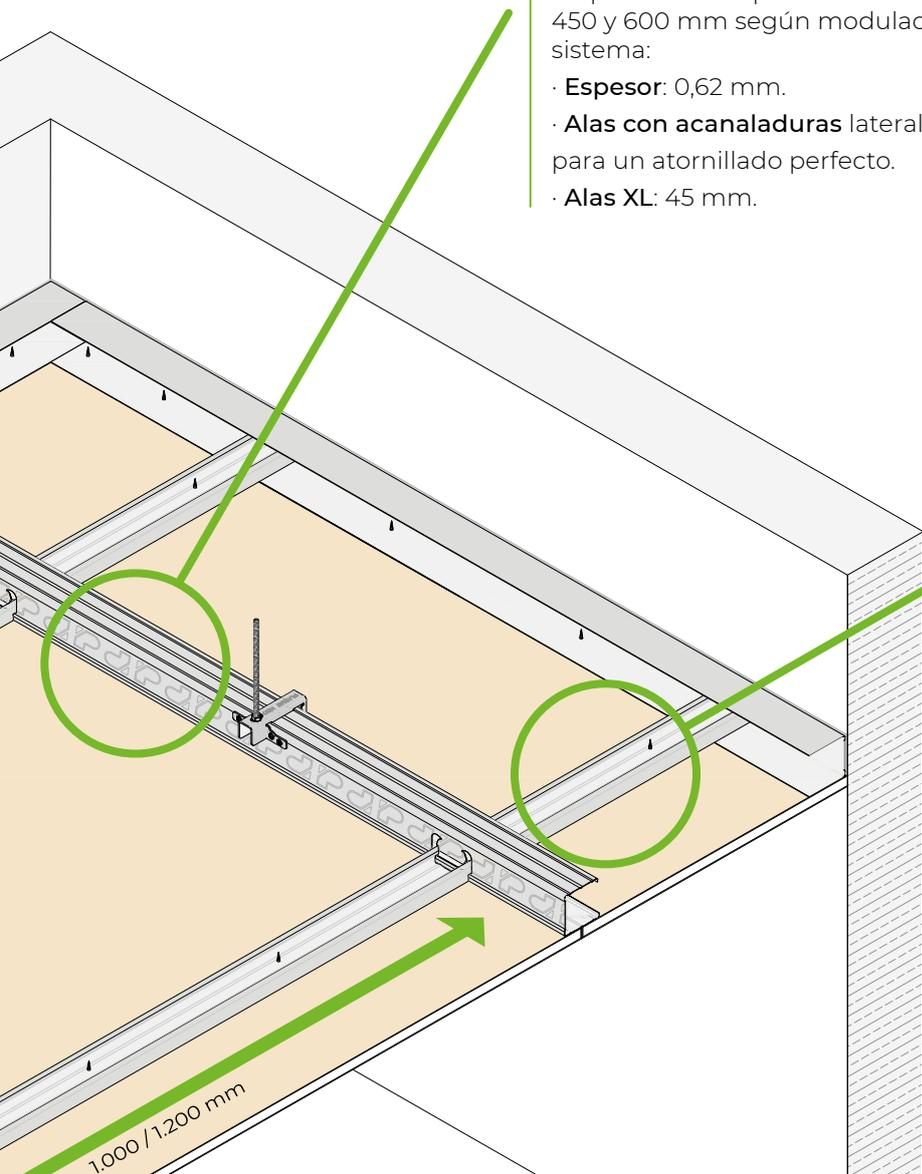
Los perfiles secundarios **Pladur® NEO** se ensamblan a la estructura primaria mediante un innovador sistema patentado de unión clipada a través de perforaciones en los perfiles primarios.
