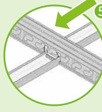
5 Por último introduce la punta de un nuevo perfil secundario (Extremo B), en la boca del perfil secundario ya colocado. **¡Encaje perfecto!**
