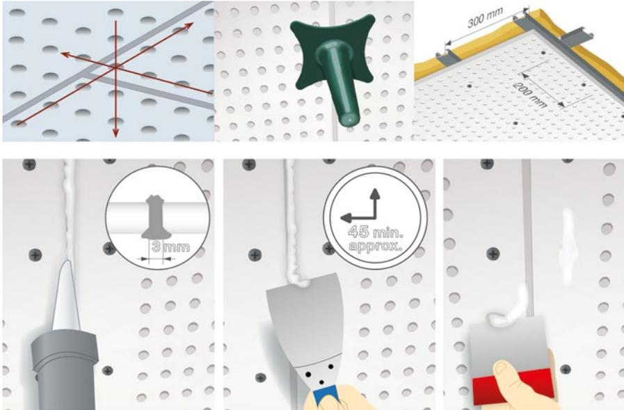
**Atornillado de placa:** Comprobar la alineación de las perforaciones en sentido longitudinal, transversal y diagonal con las herramientas de montaje Pladur® FON+ y atornillar las placas a los perfiles cada 200mm como máximo.
